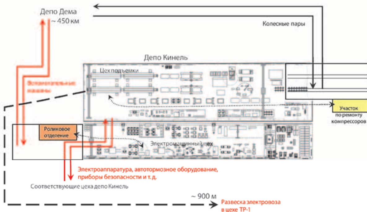
Рис. 3. Планировка цеха подъемки и электромашинного цеха
