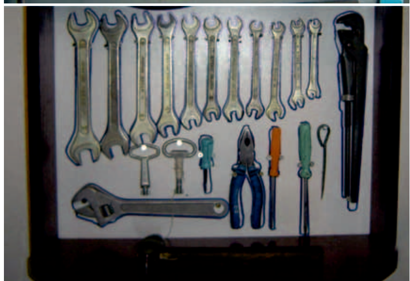
Рис. 8. Пример силуэтного хранения слесарного инструмента общего пользования ремонтного персонала
