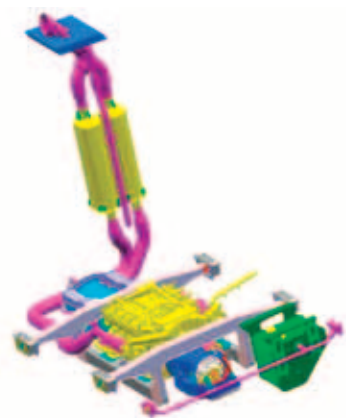
Рис. 1. Силовой агрегат C.L.E.A.N. с системой очистки выхлопных газов
