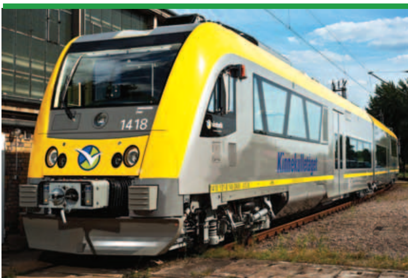
Рис. 3. Дизель-поезд ITINO, оборудованный силовым агрегатом C.L.E.A.N.
